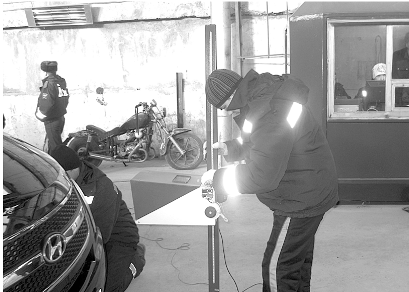
Один из этапов техосмотра – проверка параметров светового потока фар.
